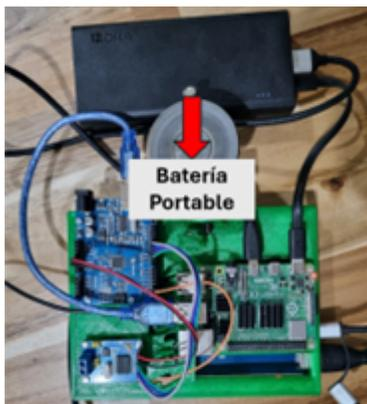
Fig.15. Clúster energizado con batería portátil.
