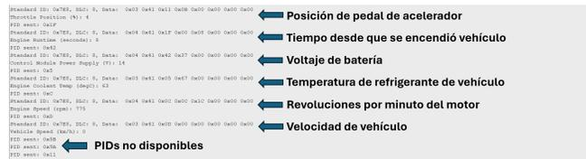
Fig.11. Monitor serial mostrando datos recibidos del vehículo.
