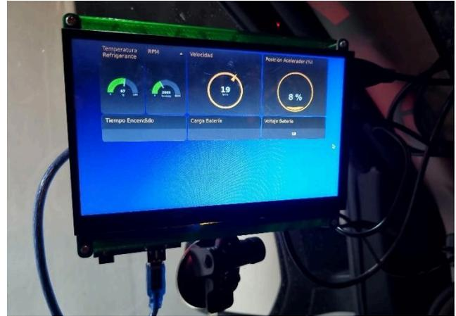
Fig.16. Clúster digital montado, evidenciando parámetros del vehículo.
