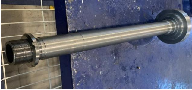
Fig. 12. Eje maquinado en torno sin perforaciones.
