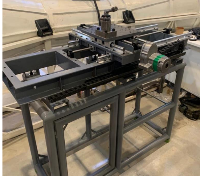
Fig. 15. Montaje de mesa coordinada en base con portaherramientas.
