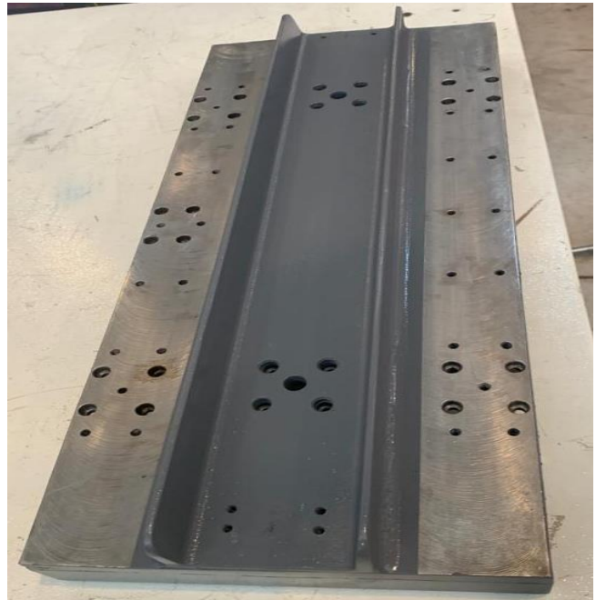
Fig. 6. Carro terminado con perforaciones, machuelados y refuerzos.
