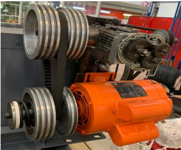
Fig. 14. Transmisión constantemente variable.
