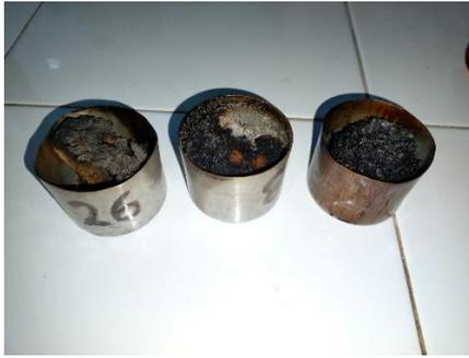
Fig. 9. Briquetas después de pasar por mufla
