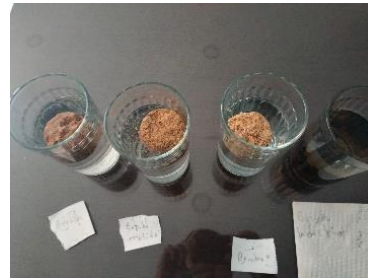
Fig. 11. Briquetas en agua pasada las primeras 24 hrs
