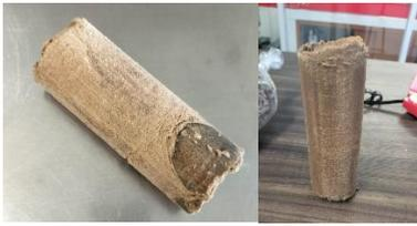
Fig. 4 y 5. Briquetas presionadas sacadas del molde
