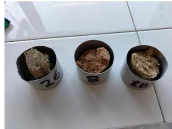
Fig. 8. Briquetas para prueba de materia volátil
