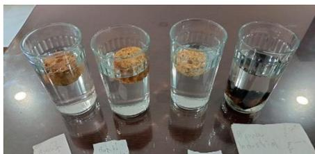
Fig. 10. Briquetas en agua para prueba de absorción
