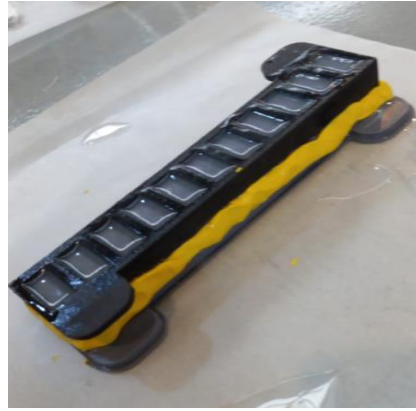
Fig. 6: Molde con mezcla de silicona.
