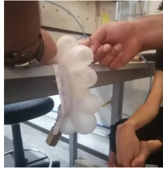
Fig. 36: Soft robot alzando 200 g después de haber distribuido el aire
