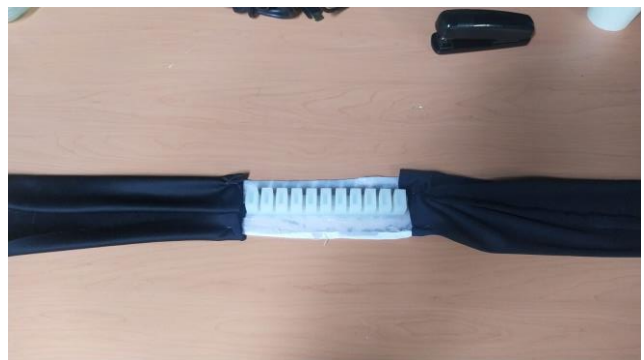
Fig. 16: Soft robot atado a la tela lycra
