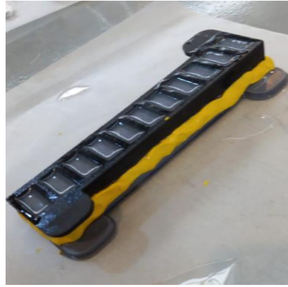
Fig. 6: Molde con mezcla de silicona.
