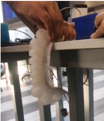
Fig. 35: Segunda prueba de fuerza del soft robot con aire comprimido
