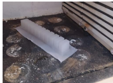
Fig. 28: Soft robot con tela inferior en horno mufla
