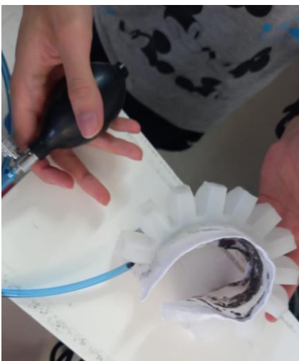
Fig. 31: Conexión válvula y cable en el soft robot.
