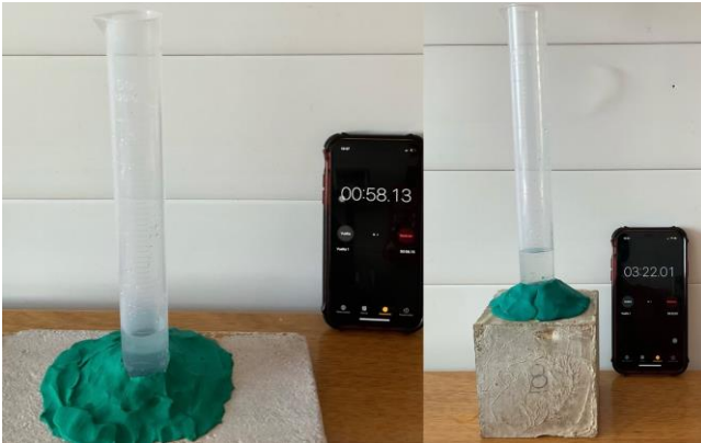
Fig. 7. Prueba de permeabilidad en mortero y petatillo.
