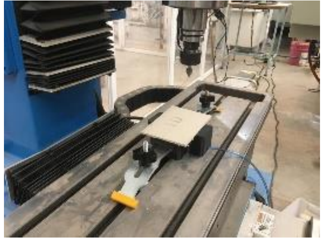
Fig. 14. Prueba de grabado de Papel Cartoncillo en la fresadora OR-40.
