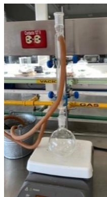
Fig. 1: Sistema de reflujo utilizado para el proceso de saponificación. Elaboración propia (2023).
