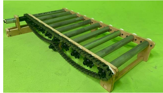
Fig.13. Banda de rodillos terminada.
