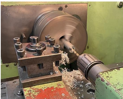
Fig. 11. Perforación del centro con broca de 7mm.
