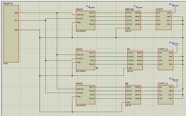
Fig. 10. Diagrama de conexiones del sistema de control.
