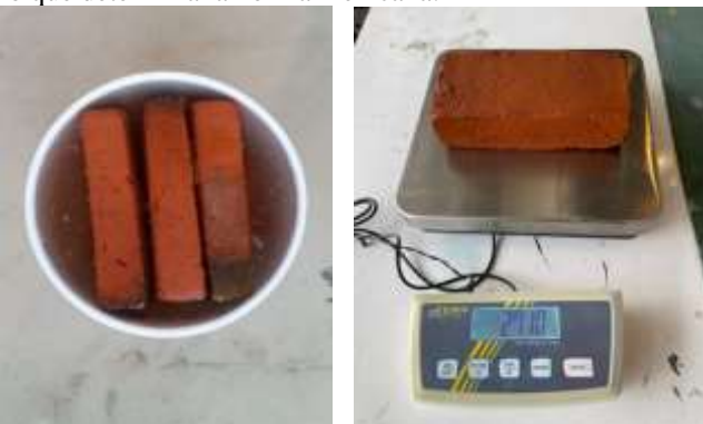
Fig. 2: Absorción total de los ladrillos.
