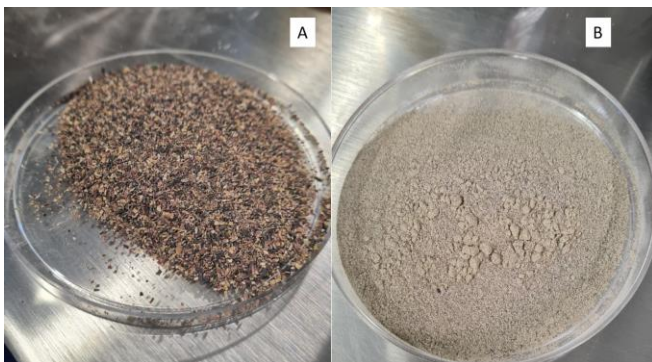
Fig. 4. A) Alga seca triturada. B) Polvo fino de alga.
