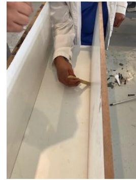
Fig. 10. Uso de pegamento y silicones para reforzar la unión de las tablas de madera.
