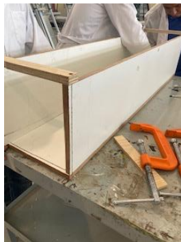
Fig.9. Unión de las tablas de madera para el armado de la caja del generador.
