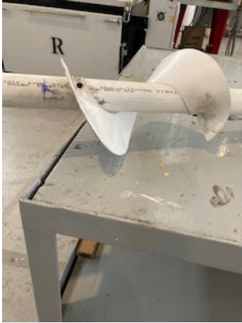
Fig. 7. Hélices pegadas al eje del tornillo usando tornillos.
