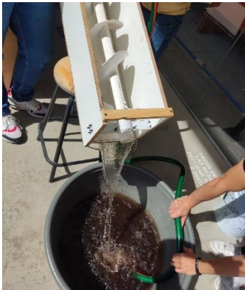
Fig. 14. Prueba final del funcionamiento del tornillo de Arquímedes
