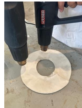
Fig. 4. Aplicación de calor a las láminas para poder estirarlas
