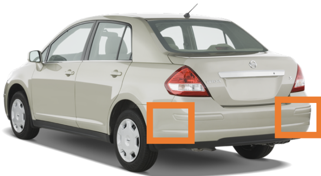
Fig. 9: Sensores de radar en un Nissan Versa. Fuente. PNGWING [25].
