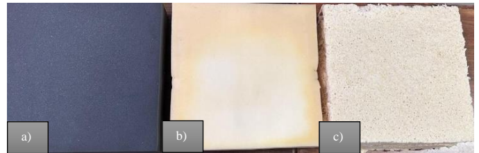
Fig. 7. Espumas empleadas prueba sensor alta presión. a) Espuma alta densidad. b) Espuma baja densidad. c) Espuma Ibero. Fuente: elaboración propia.
