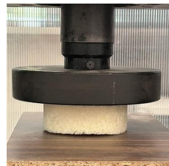
Fig. 11. Muestra cilíndrica prueba de compresión espuma Ibero en la máquina universal. Fuente: elaboración propia.
