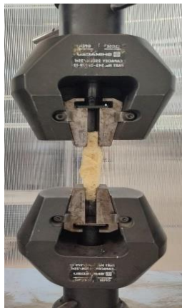
Fig. 9. Muestras de probeta espuma Ibero en la máquina universal. Fuente: elaboración propia.
