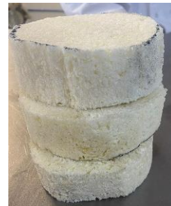
Fig. 4. Muestras espuma Ibero prueba de compresión. Fuente: elaboración propia.
