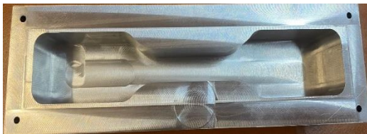
Fig. 2. Probeta prueba de tensión. Fuente: elaboración propia.
