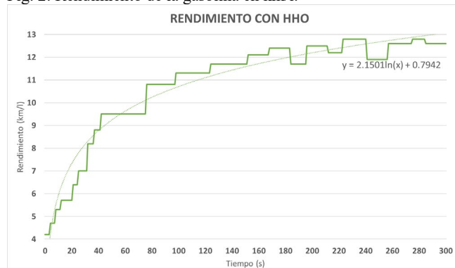
Fig. 3. Rendimiento de la gasolina con gas HHO inyectado en km/l.
