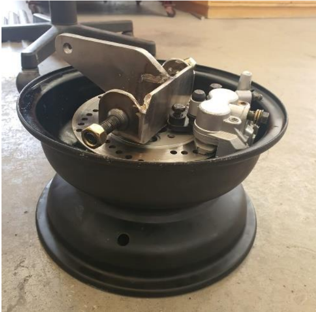
Fig. 18 Ensamble rines delanteros, disco de freno, mordazas de freno, masas delanteras y mango de dirección.
