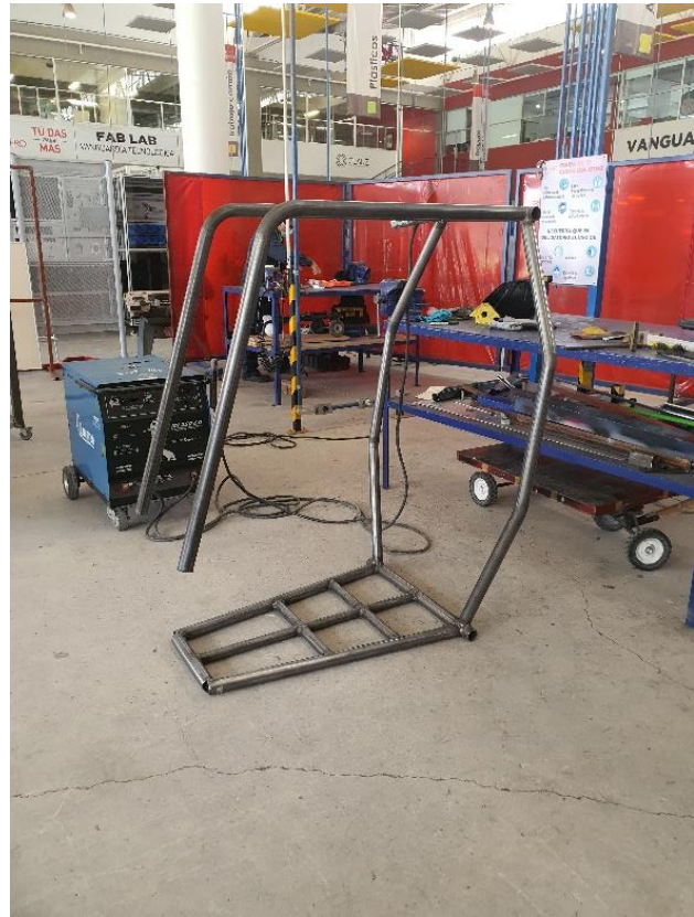
Fig. 12. Parte superior de la caja antivuelco completada.
