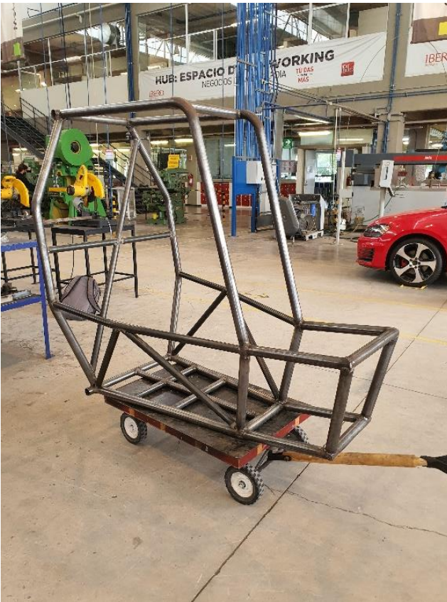
Fig. 15. Habitáculo del piloto finalizado con los refuerzos laterales.
