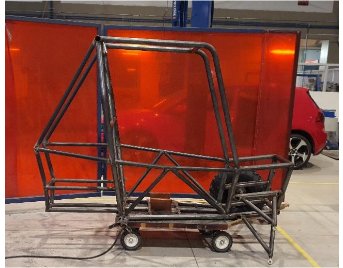
Fig. 16. Miembros traseros y brazos de suspensión delanteros colocados.
