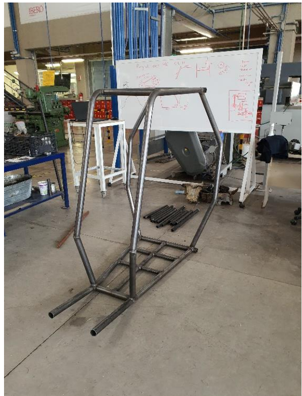
Fig. 13. Caja antivuelco completada.
