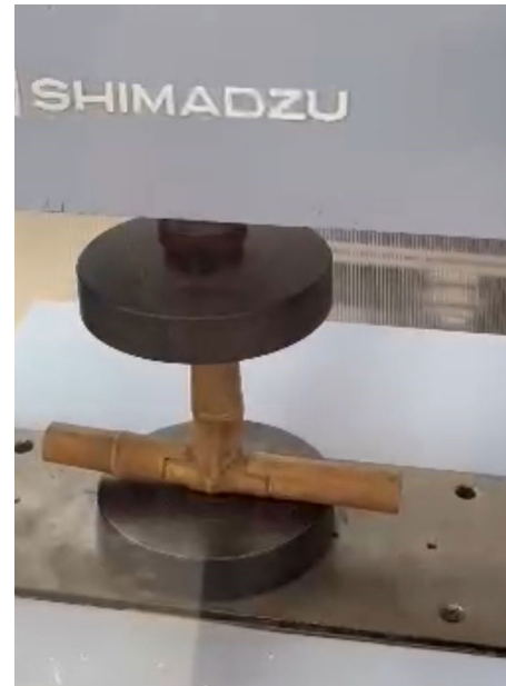
Fig. 8. Prueba a compresión de la conexión encajada en T. Elaboración propia.
