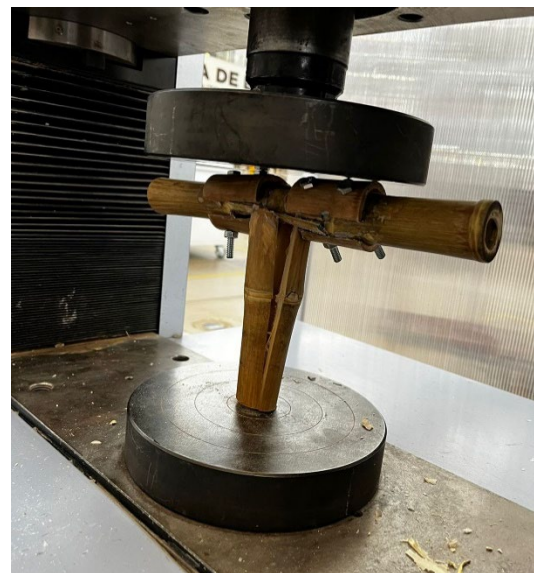
Fig. 9. Prueba a carga vertical de la conexión atornillada en T. Elaboración propia.
