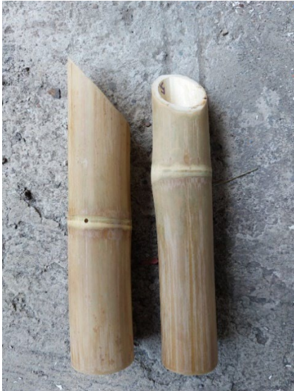
Fig. 6. Corte 45 grados de las piezas de la conexión en esquina. Elaboración propia.
