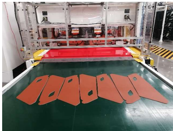
Figura 18 Puesta a punto de dado de insertos traseros
