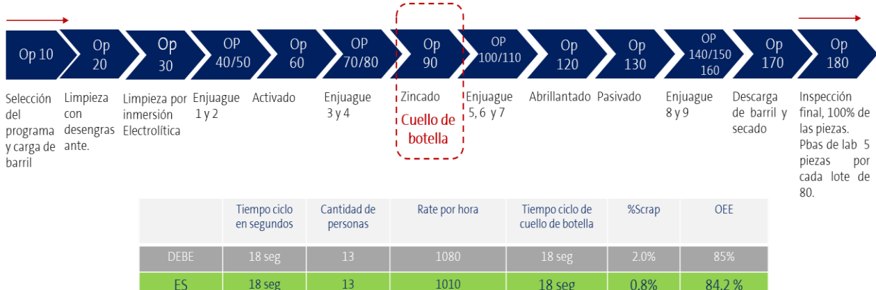
Imagen 15: Diagrama que muestra un ejemplo de un mapeo de proceso de un proveedor con todo en verde.
