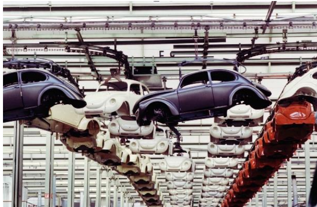
Imagen 5: Se observa línea de carrocerías pintadas En la planta de Puebla.
