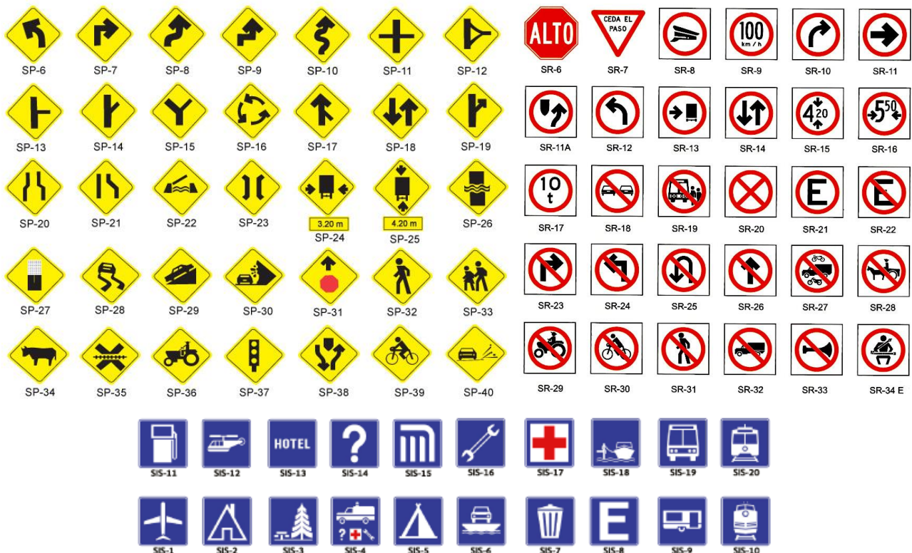
Imagen 40. Señalamientos preventivos, restrictivos e informativos de servicios Fuente: Secretaría de Comunicaciones y Transportes
