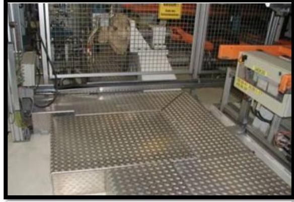
Ilustración 42, condición final, una vez implementada la mejora, la cual impide el daño prematuro y el acumulamiento de polvo y basura. Fuente, elaboración propia del alumno.
