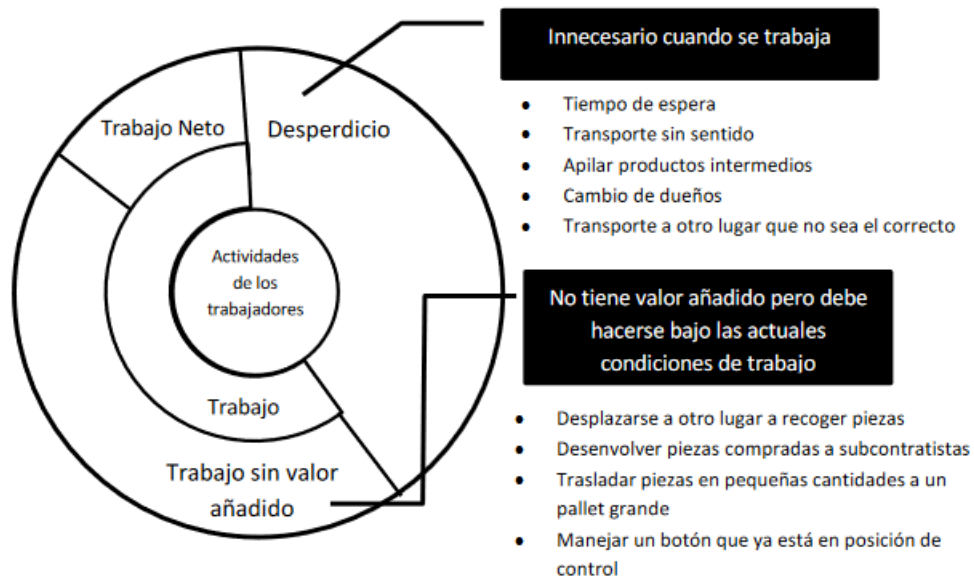
Ilustración 10, sistema de producción Toyota, como entender la función de fabricación. Fuente El sistema de producción Toyota Taiichi Ohno 1991.
