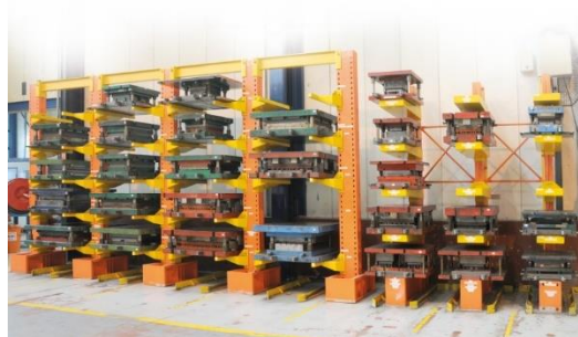
Ilustración 27 Almacén ideal de troqueles [24]
