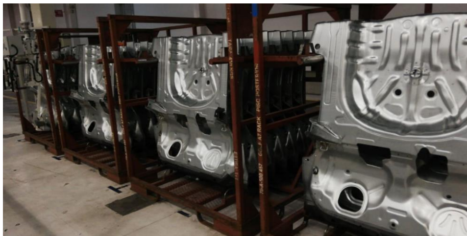
Imagen 18 Acomodo de Racks charola Piso Trasero
