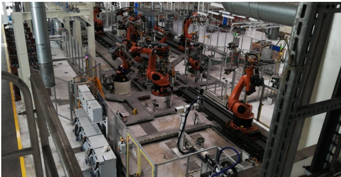
Imagen 19 Línea automática Piso Trasero
