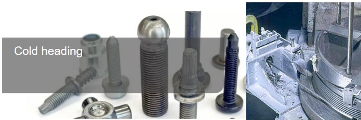
**Figura 16.** Procesos de trabajo en frío: piezas de acero forjadas progresivamente en frío<sup>[40]</sup>, trefilado en frío<sup>[41]</sup>
