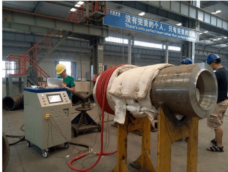
Figura 19. Tratamientos térmicos de aceros: relevado de esfuerzos por calentamiento con inducción eléctrica [47]
