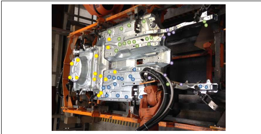
Figura 27. Colocación de pernos en plataforma.
