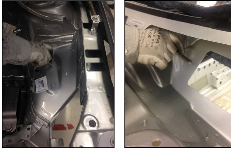
Figura No. 32. Deformación de Pernos para llegar al estado DEBE
