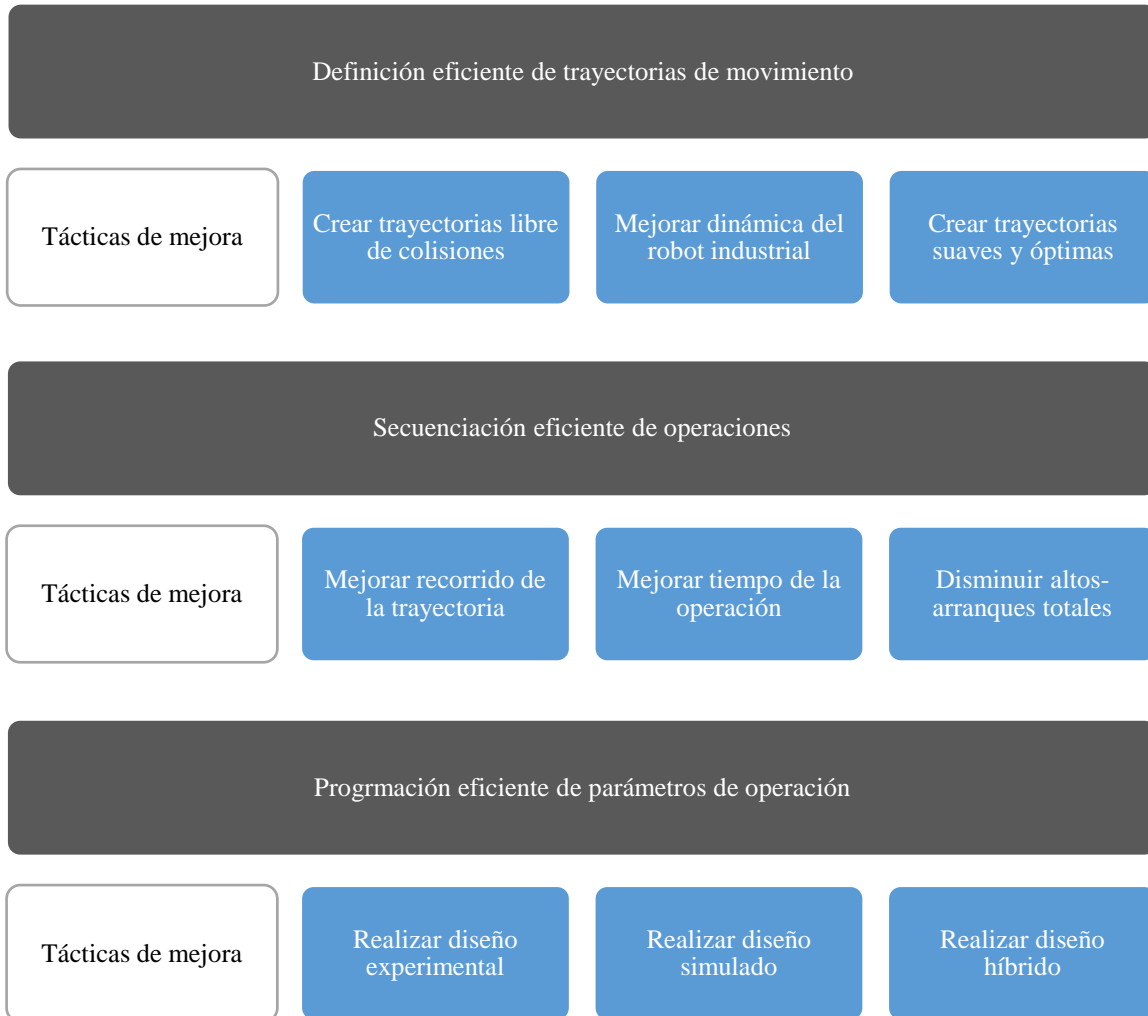
Figura 5.2 Reducción de consumo energético (programación del robot)
