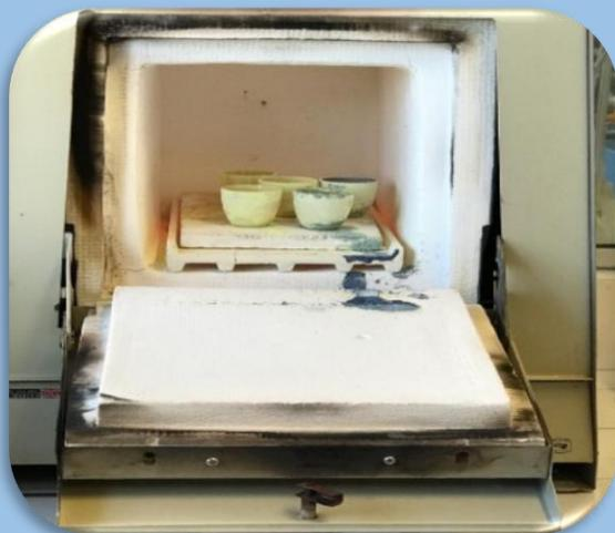
Se esperó a que se enfriaran los crisoles para obtener el fotocatalizador.
