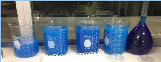
Después del baño ultrasónico se agitaron 10 min, y luego fueron colocadas a la luz del sol para que los fotocatalizadores fueran activados.
