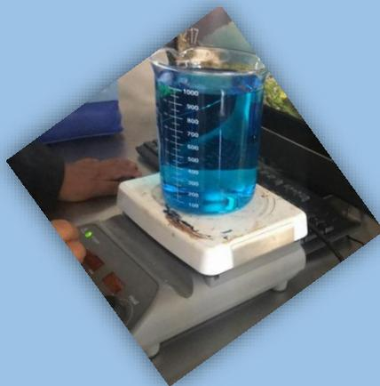
Se procedió a llenar un vaso de precipitado de 1 L, se agitó durante 15 minutos para obtener una mezcla homogénea.
