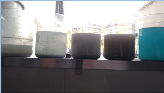
Se dejó precipitar hasta que el fotocatalizador purificara las soluciones con ayuda de la luz solar.
