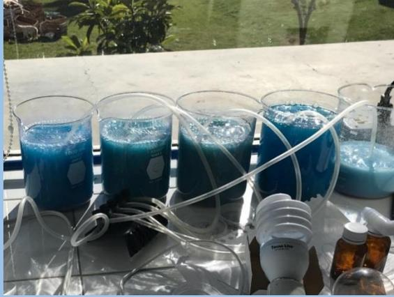
Se colocó una bomba de aire durante un par de horas para que tuvieran una agitación constante.
