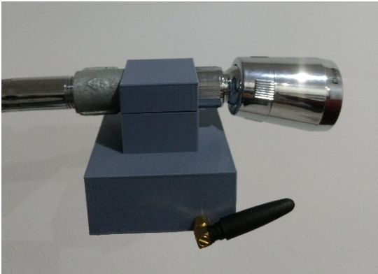
Figura 1. Imagen del dispositivo incorporado a una regadera de baño.
