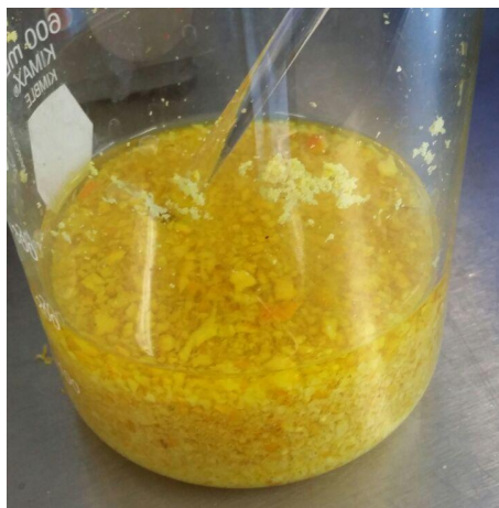
Figura 1. Cáscara molida con hexano en el momento de la extracción.
