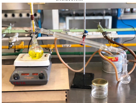
Figura 2. Destilación de mezcla del aceite de la cáscara con el hexano.
