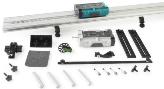
Fig. 3. Sistema dinámico de riel y carrito de Vernier Inc. [1].
