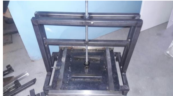
Foto1. Prensa de termoformado terminada.
