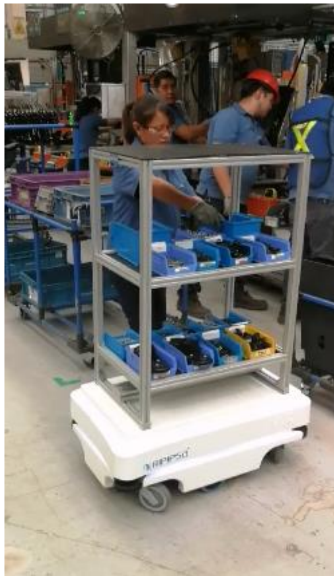
Imagen 4.- Surtimiento de materiales por medio de AMR Fuente: Empresa metalmeccánica de fabricación de autopartes
