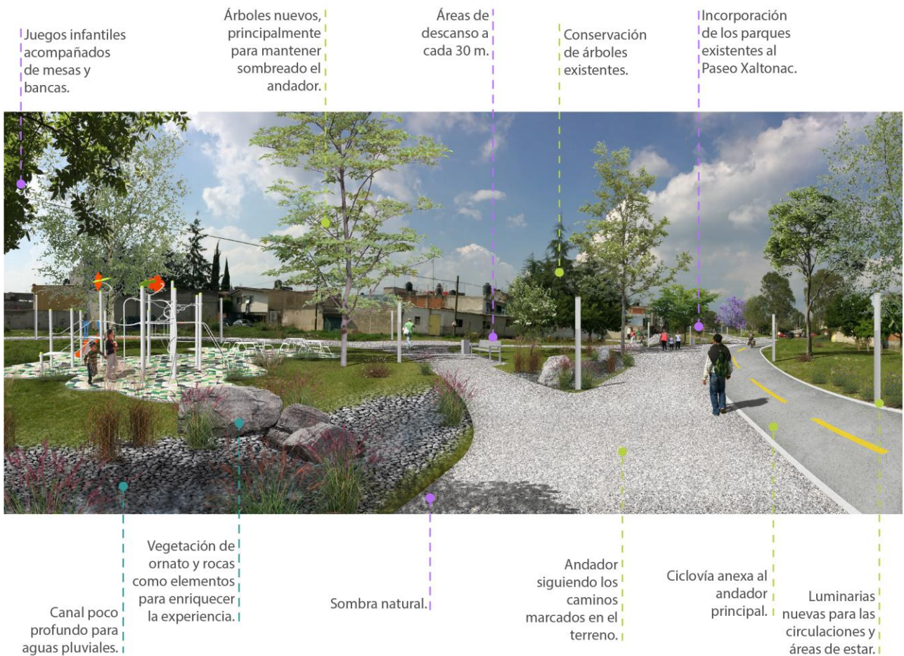
Ilustración 37. Estado actual y propuesta para una sección del Paseo Xaltonac. Elaboración propia a partir de fotografía tomada por la autora.
