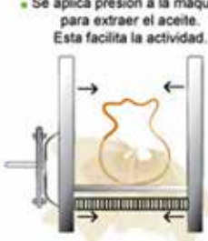
• Una vez envuelta la masa en la tela se coloca entre las placas de la prensa.
