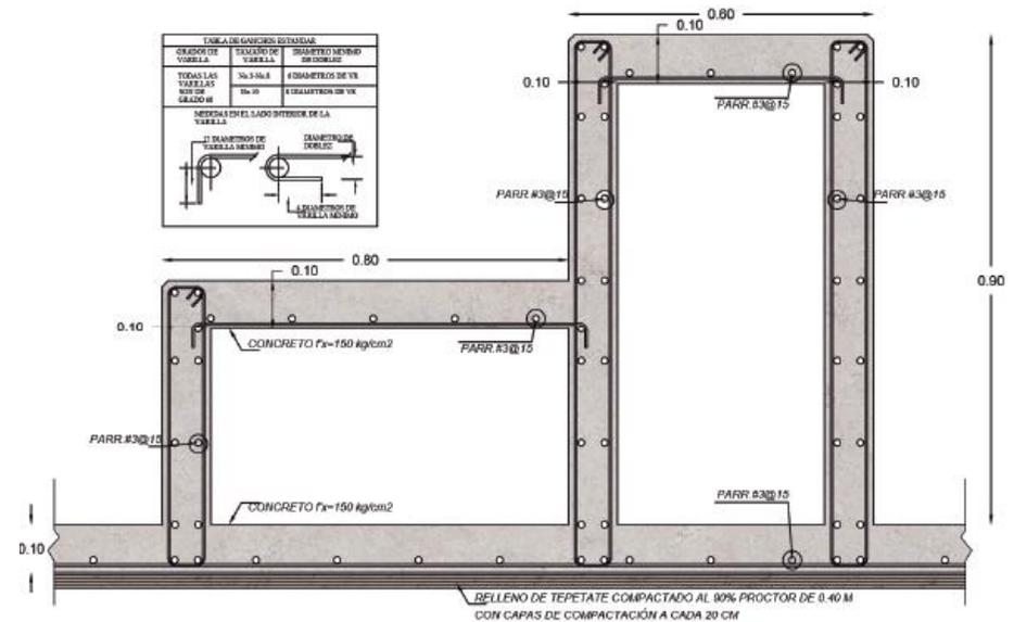
Figura 8.12: Detalle constructivo de nuevas gradas. (Autoría 2017).
