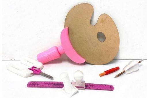
Fig. 1. Prototipos impresos en 3D con PLA
