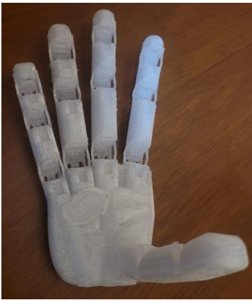
Fig. 2. Prototipo final impreso utilizando TPU 85A.
