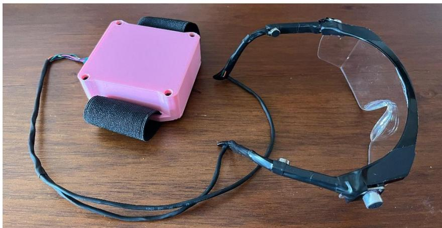
Fig. 5. Prototipo final de la ayuda técnica: lentes de alerta háptica para personas con discapacidad auditiva. Los micrófonos se encuentran fijados al marco del armazón de los lentes y los motores a cada varilla. La parte que se coloca en el brazo contiene las conexiones al microcontrolador y la batería dentro de la caja impresa en 3D.
