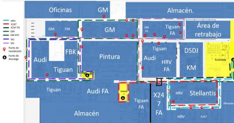
Figura 2. Identificación de puntos de recolección y rutas actuales en la planta
