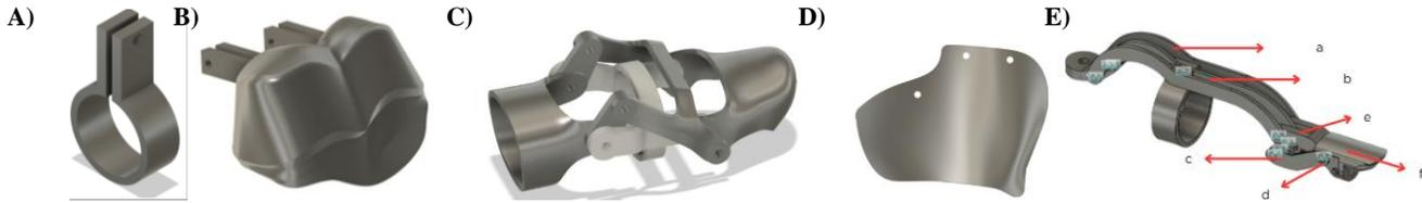
Fig.2. Diseño de la prótesis. A) Anillo para el dedo índice B) Mecanismo de sujeción para dedo medio y anular. C) Diseño del mecanismo para el dedo meñique. D) Base diseñada acorde al dorso de la mano del paciente. E) Mecanismo de la prótesis constituido por las siguientes piezas:
