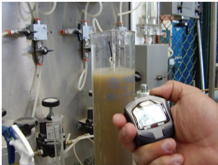
Figura 3.12. Prueba del hidrómetro.
