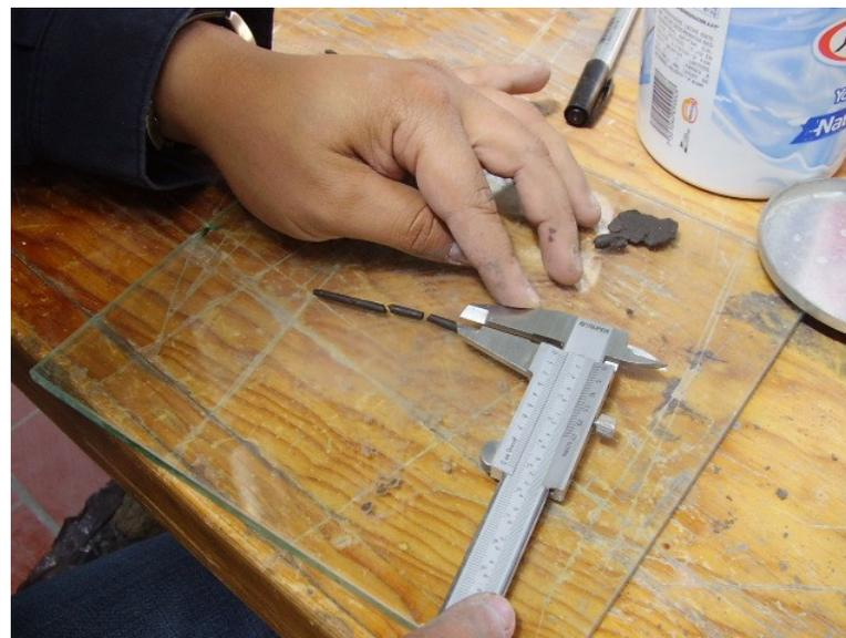
**Figura 3.14.** Determinación del límite plástico.
