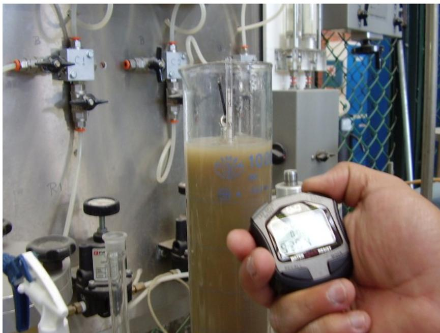
Figura 3.12. Prueba del hidrómetro.
