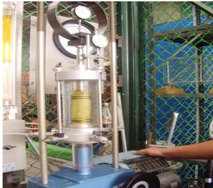
**Figura 3.20.** Prueba triaxial rápida R, no consolidada no drenada.
