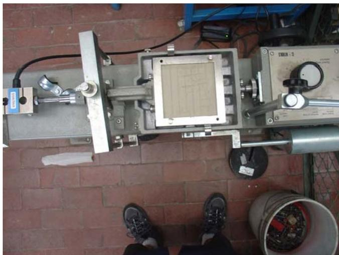
**Figura 3.23.** Mecanismo para la prueba de corte directo
