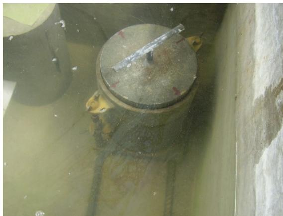
**Figura 3.17.** Proceso de saturación de la muestra, mediante inmersión en agua.
