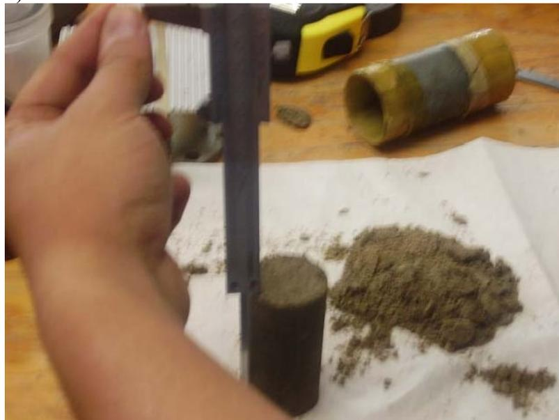
Imagen 5: a) labrado de muestras; b) medición de muestras labradas.
