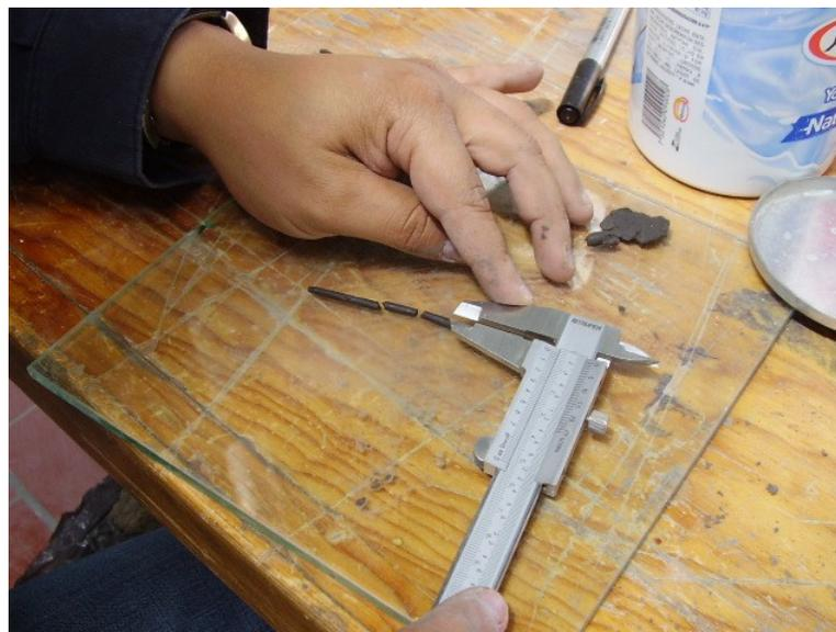
**Figura 3.14.** Determinación del límite plástico.
