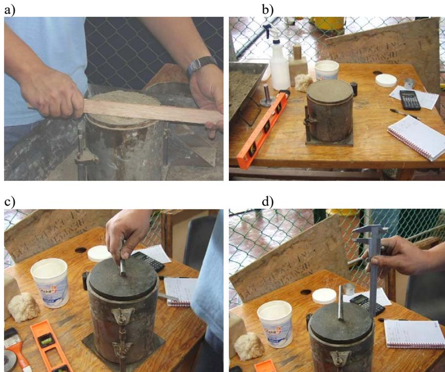
**Figura 3.16.** Enrase del material y medición inicial.
