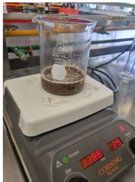
Fig. 2. Polvo de sargazo con H_2O_2 , calentándose.
