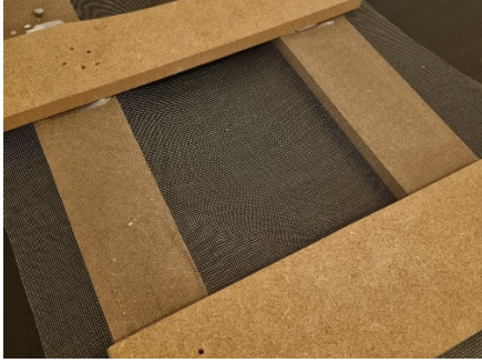
Fig. 7. Cedazo de 14 cm de largo por 10.5 cm de ancho
